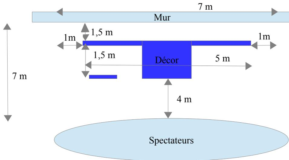
L'ossature du décor est en tubes d'aluminium recouverts de tissus (pour cette raison le plein vent est vraiment à éviter). Nous avons la possibilité de replier le décor pour le transporter sans le démonter (2 personnes supplémentaires nécessaires).
